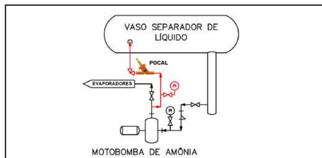
Segurança - controle de pressão máxima na saída da bomba de amônia.
